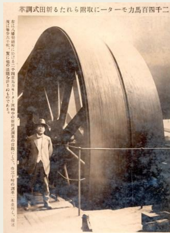
八幡製鉄所へ納入した革ベルト（大正14年）30インチ幅2本掛 原動機は2400馬力
